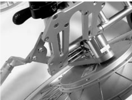
Abb. 4 Befestigungsbolzen in die Aufnahme einhängen
