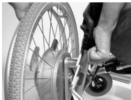
Abb. 8 Demontage des Antriebsrades
