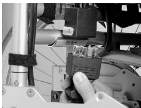
Abb. 17 Abziehen des Zentralsteckkontakts
