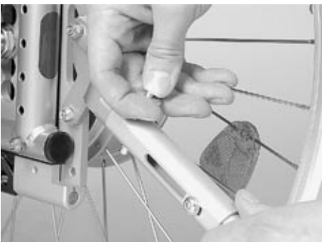
Abb. 22 Lösen des Verriegelungsstiftes
