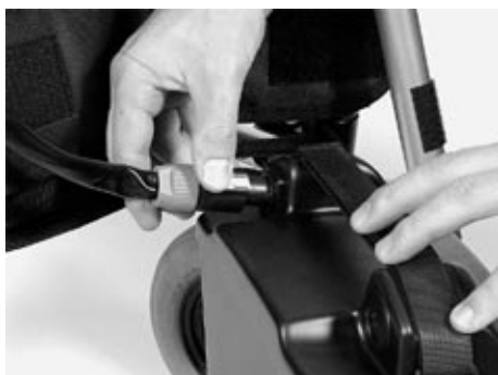
Abb. 15 Abziehen des Batteriekabels
