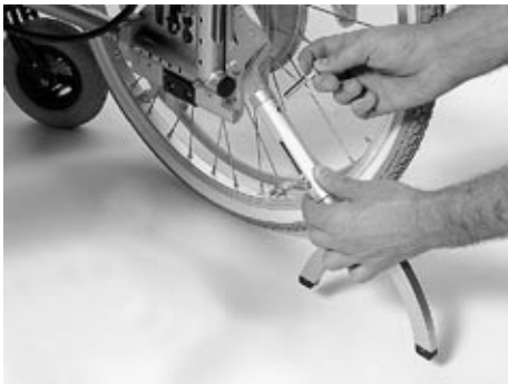
Abb. 23 Abziehen des Pendelkippschutzes
